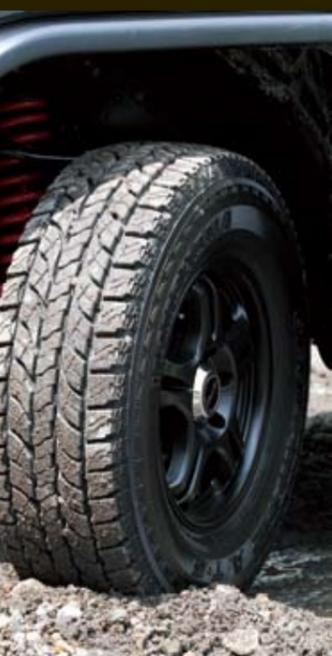
縦に4本の凸凹ラインが荒れた路面をしっかりと捉える。複雑なブロックデザインは目詰まりを抑えるのに一役買っている。
