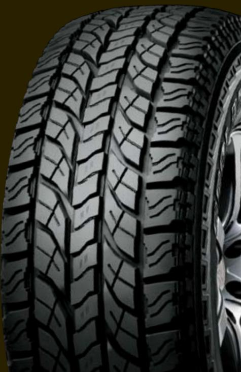
4本のストレートグループに、複雑なカタチをしたブロックを配置しているジオランダー A/T-S。すべてのブロックを段形状にしたDare2ブロックや、面をくり抜いたようなデュアル3D形状のブロックから生み出されたタイヤである。サイドウォールは耐カット性やマッドトラクションを向上させるアグレッシブサイドプロテクターを採用している。
